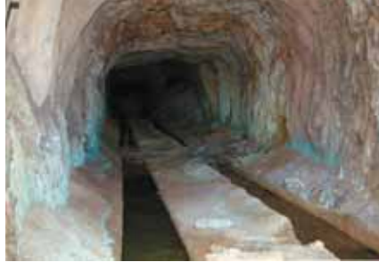
Travers banc creusé par Deligny dans le filon nord de la mine de Tharsis.
